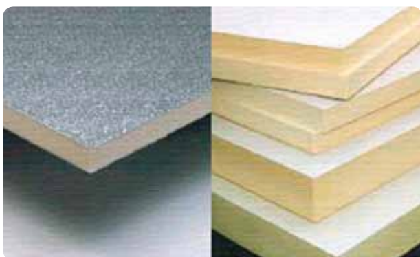
Bild 15: Isoleringsplattor tillverkade av fast polyuretanskum (PUR/PIR) med aluminiumfolie och andra beklädnader.
