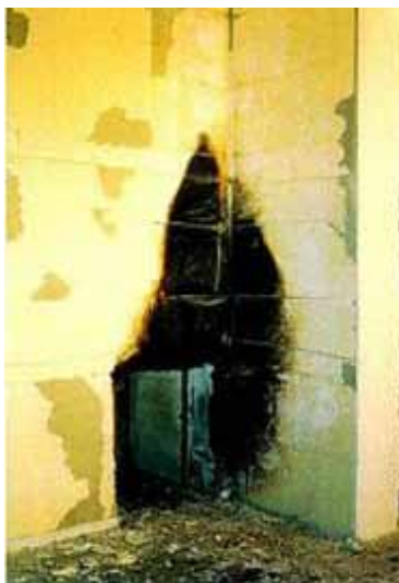
Zniszczenia próbki: warstwa izolacji PU
