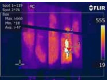
Układ badawczy zgodnie z EN1365-1: Próbka od strony nie wystawionej na działanie ognia i zapis termowizyjny w trakcie badania
